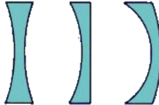
diverging lens (concave lens)
